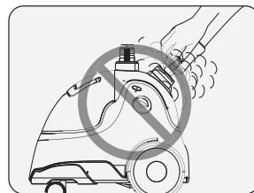
**ห้าม** ดึงข้อต่อท่อไอน้ำออกเด็ดขาด ในขณะที่ห้ามหรือไอน้ำในเครื่องยังร้อน
